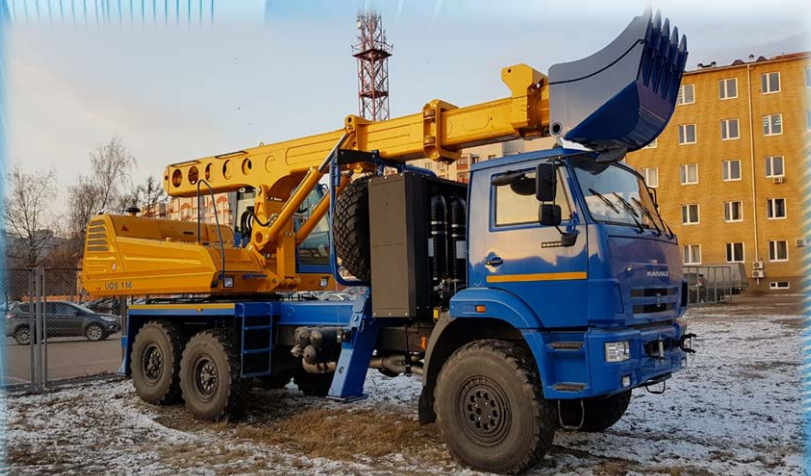
UDS 114_KAMAZ_43118 с газовым двигателем
